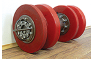
Манжетно-дисковое очистное устройство «ВОСТОК-МД» с установленным спереди регистратором «ВОСТОК-ВР» перед испытаниями.
